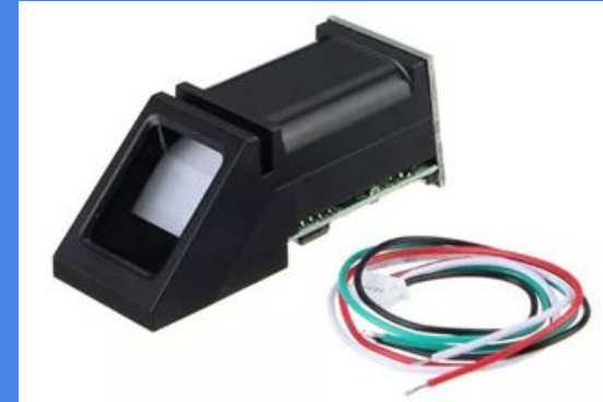
DSP integrado. Almacena hasta 1000 Huellas. Comunicación Serie
