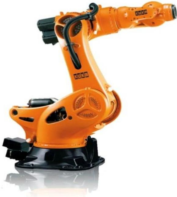
Ejemplo de robot manipulador industrial, que presenta el mismo formato estructural y lógica de funcionamiento que robot manipulador MENTOR, con la diferencia que la estructura es más robusta y precisa tal como lo demanda el ambiente industrial.
